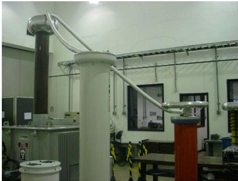
Figura 16 - Divisor padrão do INMETRO (divisor vermelho) para ATCA de 1-200 kV
