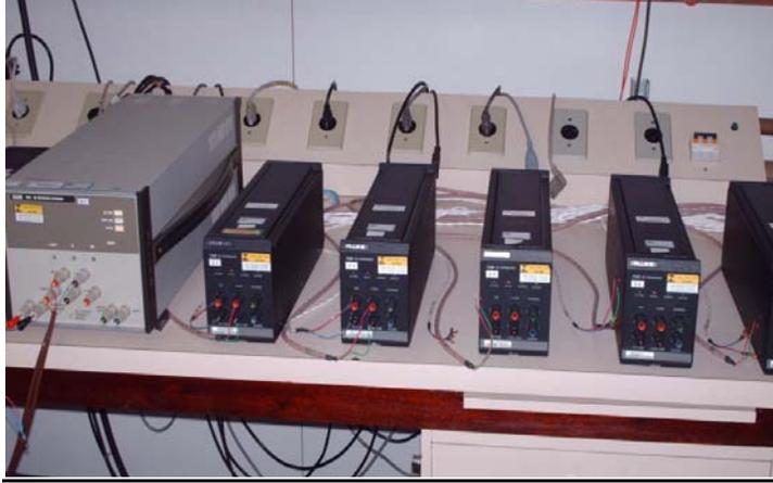
Figura 11 - Conjunto de pilhas eletrônicas padrão do INMETRO de 1,018 V e 10 V
