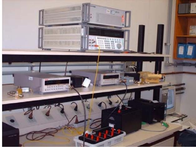
Figura 14 - Instrumentos utilizados na transferência do padrão CC para CA
