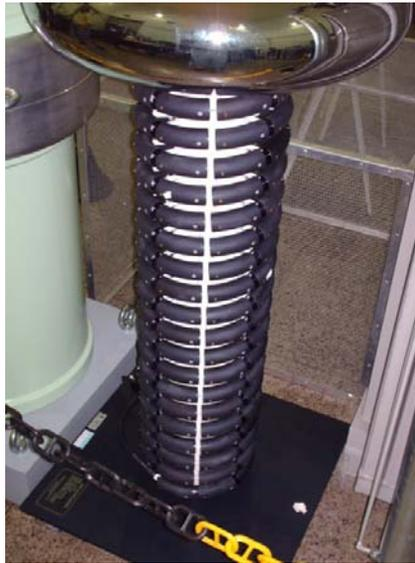
Figura 13 - Divisor padrão do INMETRO para HVDC até 150 kV
