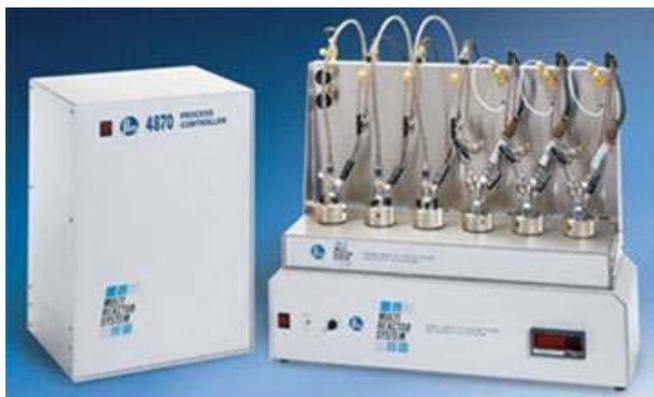
**Figura 17 - Sistema de multi-reatores da Parr usado nos experimentos**
