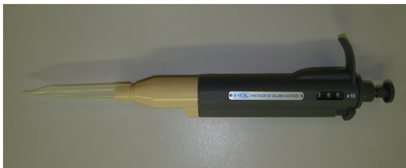
Figura 3.6: Pipeta de volume ajustável usada na preparação das emulsões.
