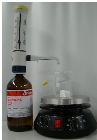
Figura 3.2: Dispensador de glicerina e agitador magnético usados no processo de homogeneização da fase contínua.
