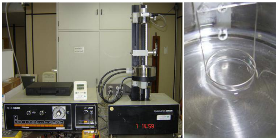
Figura 3.5: Tensiômetro LAUDA VO 2001 e anel utilizado na medição da tensão superficial da fase contínua.
