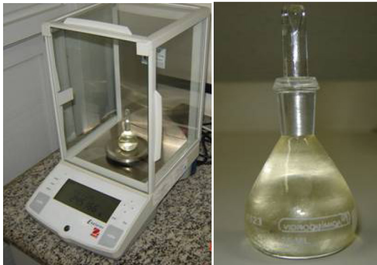
Figura 3.4: Balança e picnômetro utilizados na caracterização das fases.
