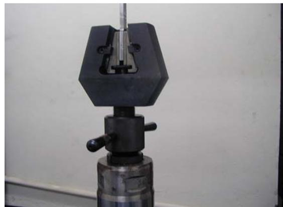
Figura 4.4: Montagem e fixação do corpo de prova.
