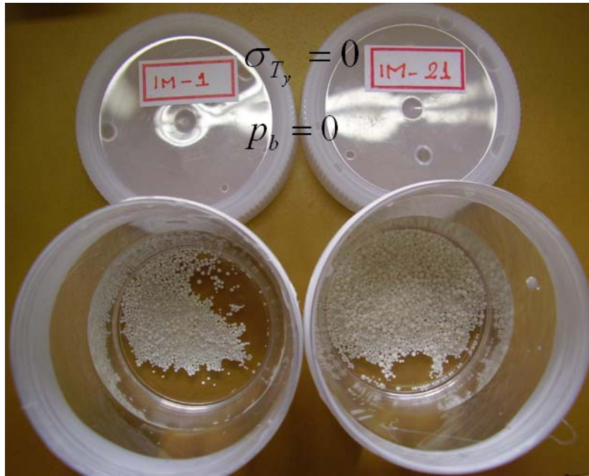
Figura 6.1: Condições experimentais na determinação do inchamento (Inchamento livre).
