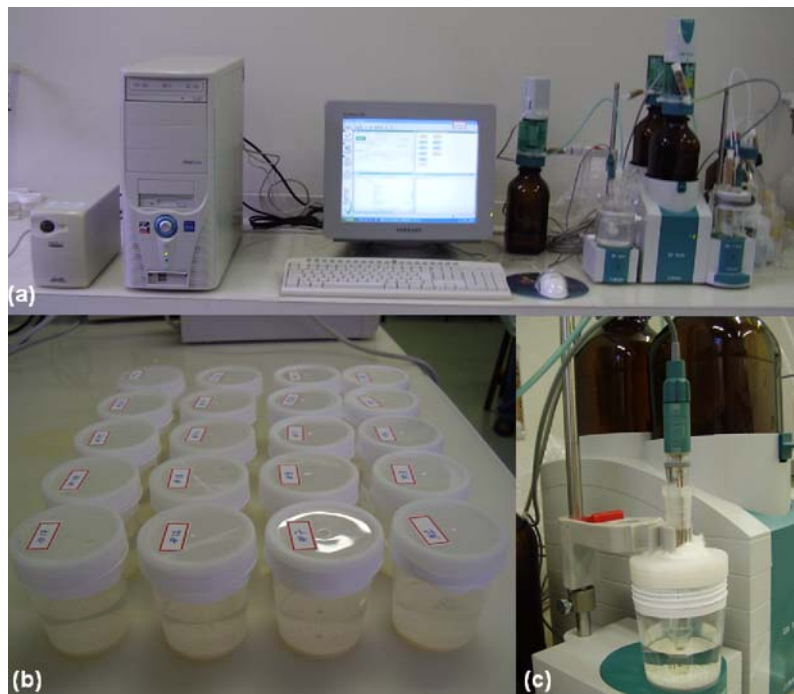
Figura 3.3: (a) Titulador automático do Departamento de Química da PUC-Rio. (b) Titulação em batelada ou batch . (c) Medida do pH.
