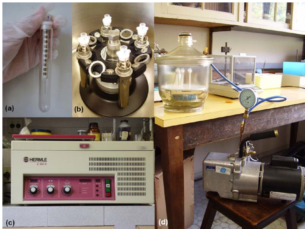
Figura 3.14: Processo de medida do inchamento da resina. (a-c) Centrifugação. (d) Secagem a vácuo.
