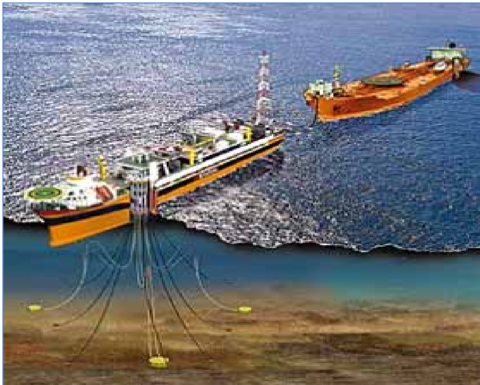
Figura 3 – Representação de uma plataforma tipo FPSO realizando operação de offloading para um Navio Aliviador (TWI, 2010).
