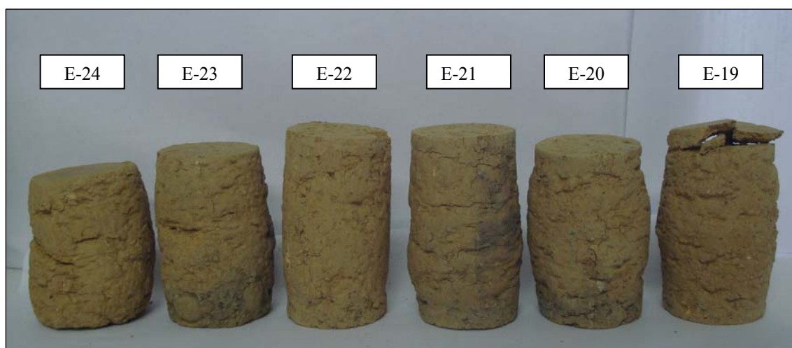
Figura 6.15: Corpos de provas com \sigma'_c=200 kPa após os ensaios no solo do Quitite.
