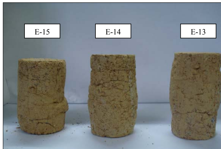
Figura 6.11: Corpos de provas com \sigma'_c=20 kPa após os ensaios no solo de Quitite.
