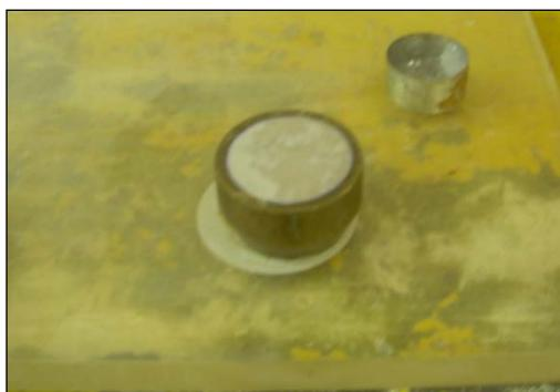
Figura 4.10: Amostrador contendo o solo após de ser submetido a sucção e capilaridade para saturar-lo.
