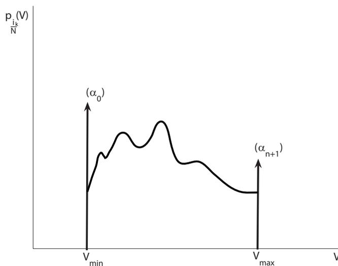
Figura 3.1: Função densidade de probabilidade das parcelas individuais de interferências externas
