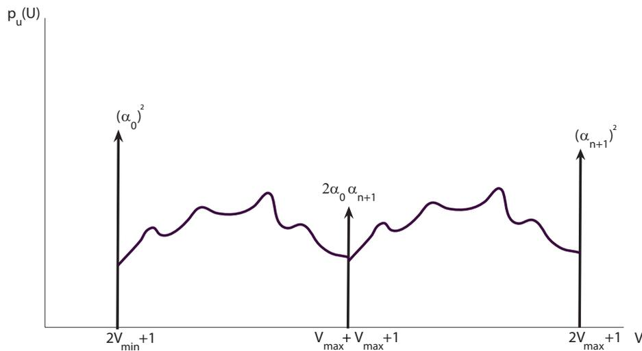
Figura 3.4: Função densidade de probabilidade da soma de duas parcelas individuais de interferência
