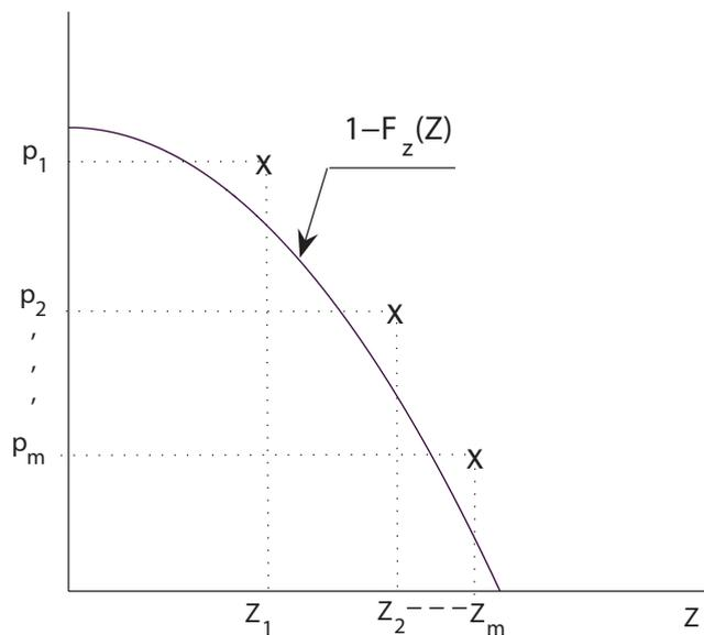
Figura 2.1: Distribuição cumulativa de probabilidade da degradação devida a chuvas e interferências externas.
