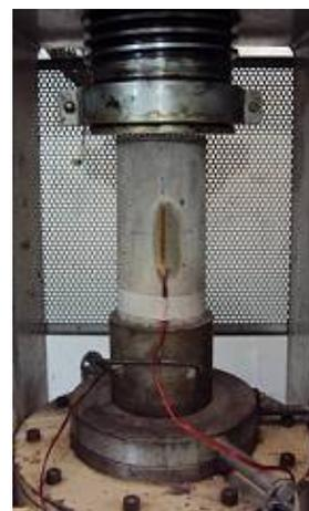
a) Ensaio de resistência à tração
