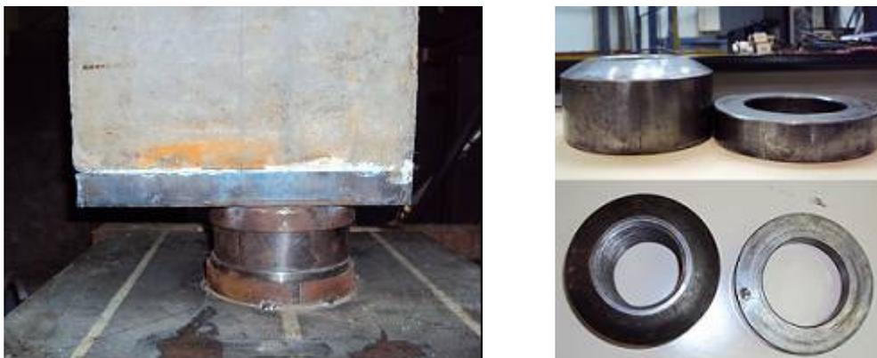
Figura 3.23 – Posicionamento do pilar com a excentricidade inicial e detalhe da rótula universal utilizada na 1ª série
