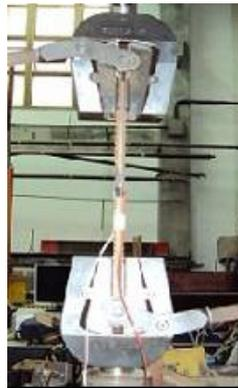
Figura 3.14 – Ensaio de resistência à tração do aço
