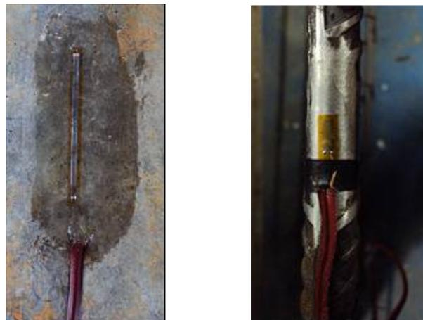
Figura 3.20 – Extensômetros elétricos colados na superfície de concreto e de aço
