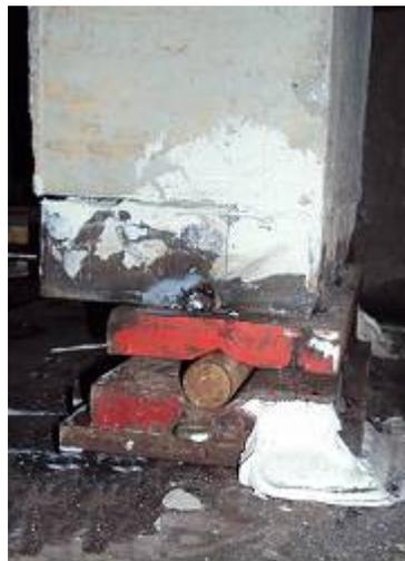
Figura 3.25 – Posicionamento do pilar com a excentricidade inicial da 2<sup>a</sup> série
