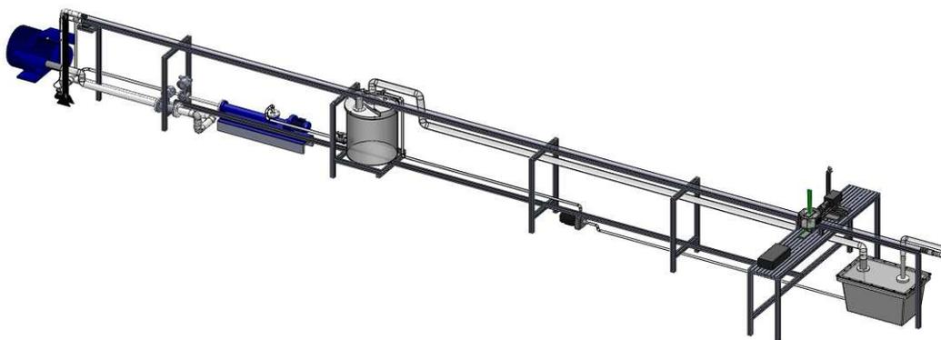
Figura 4.12 - Visão geral da seção de testes com tubo de diâmetro de 50.8 mm.
