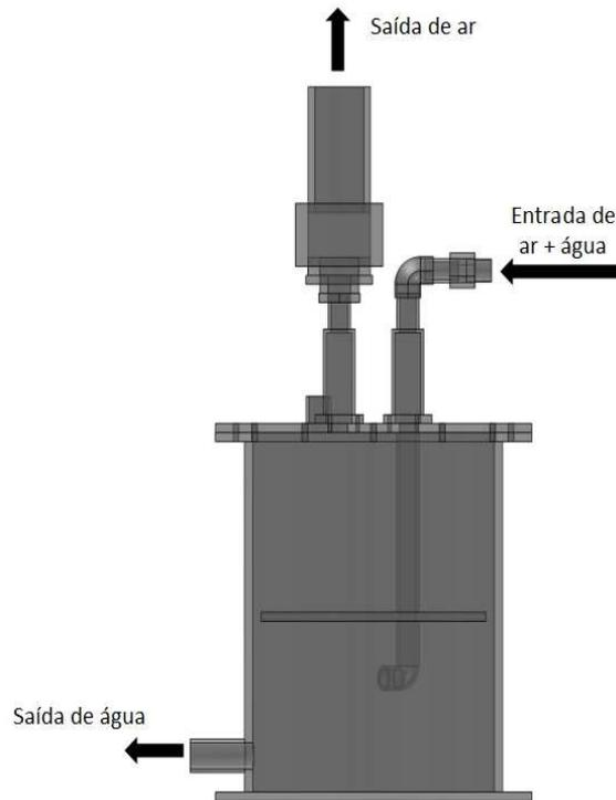
Figura 4.5 - Vista do tanque com destaque para a placa separadora em seu interior.
