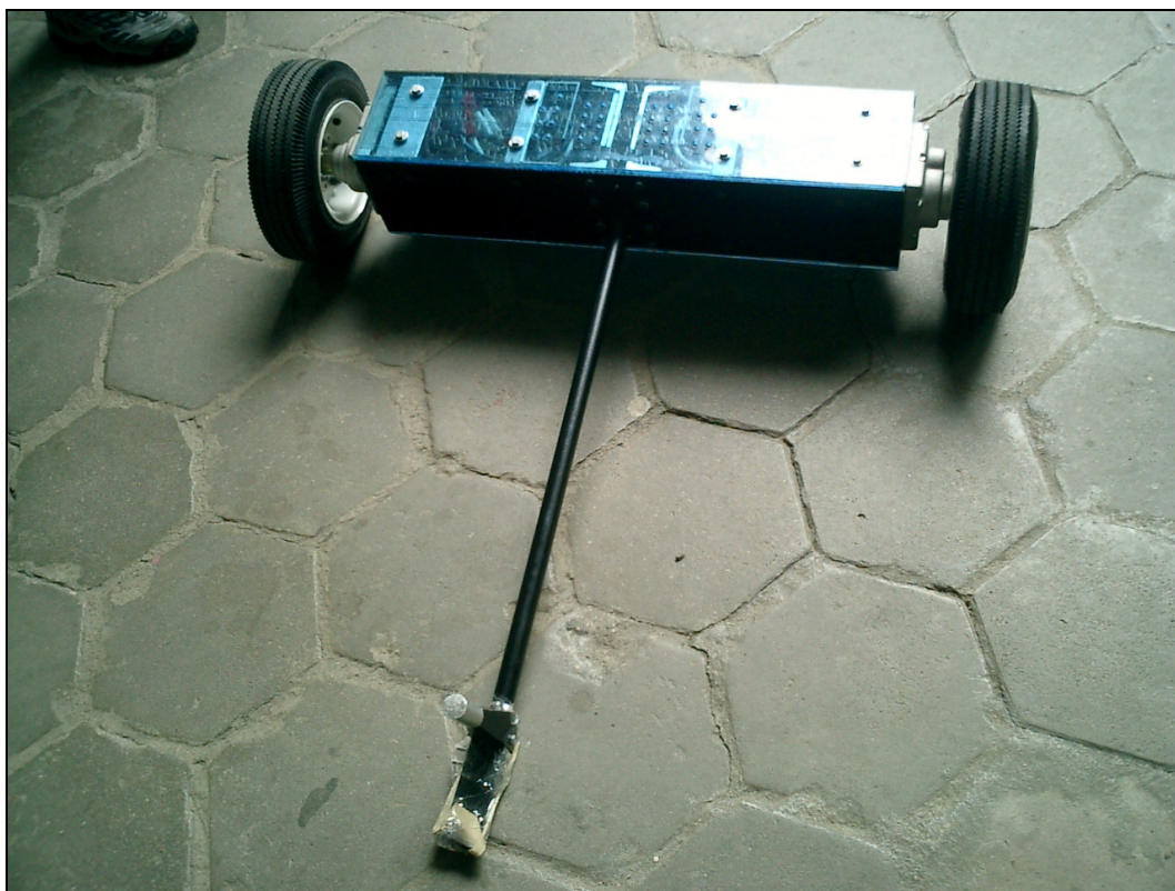
Figura 40: Robô original de onde foram aproveitadas a base da estrutura de alumínio, motores, rodas e eletrônica de potência.
