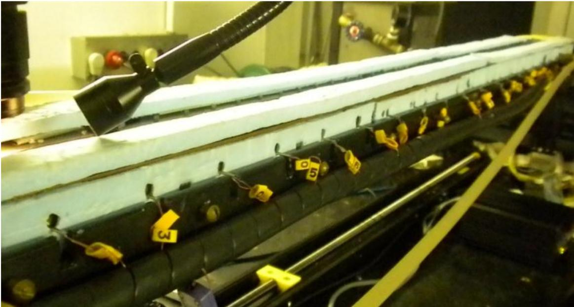
Figura 3.12: Imagem da disposição dos termopares na seção de teste
