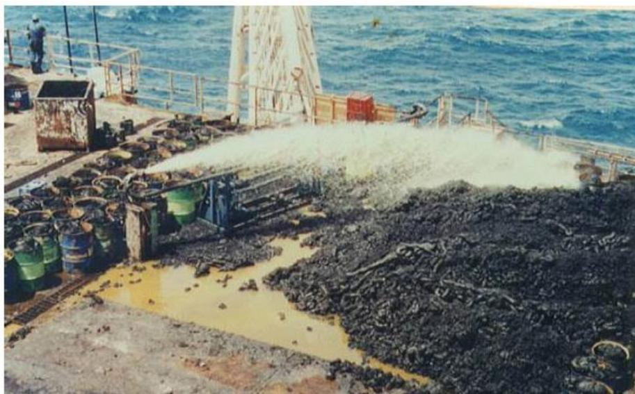
Figura 1.3 - Operação de remoção de parafina na plataforma PXA – 3
