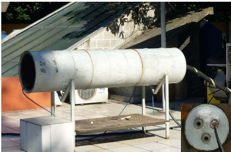
Figura 8: Tambor para a medição de vazão de ar na entrada do coletor de admissão
