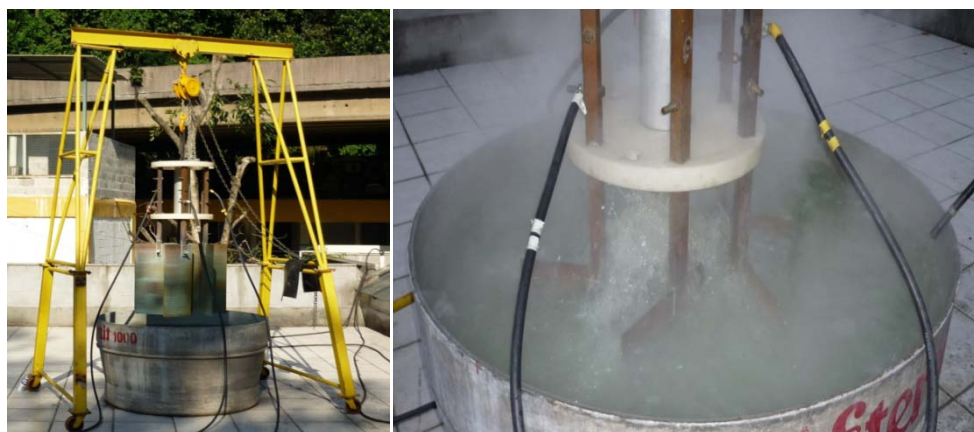
Figura 16: Arranjo do dissipador de carga
