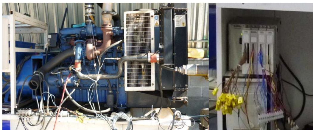
Figura 13: Arranjo dos transdutores de pressão e tomadas de temperatura; no lado direito a tomada dos sensores para a leitura de dados
