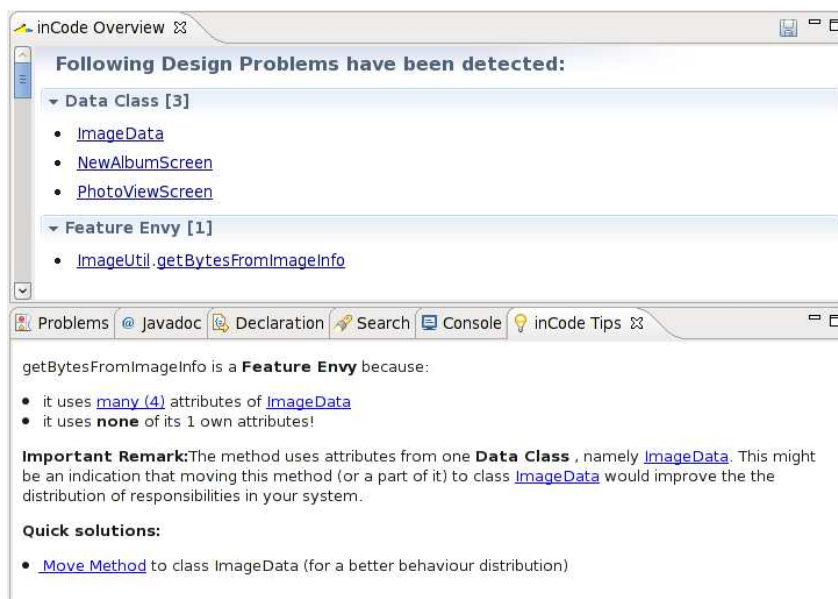
Figura 3.5: inCode: detecção de anomalias e sugestões de refatoração
