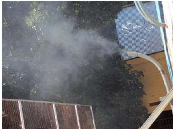
Figura 51 – Foto do escapamento operando em modo Diesel
