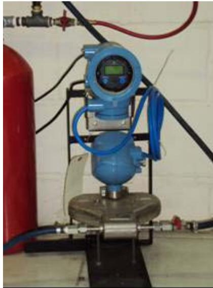
Figura 19 – Corioli utilizado para a medição do combustível
