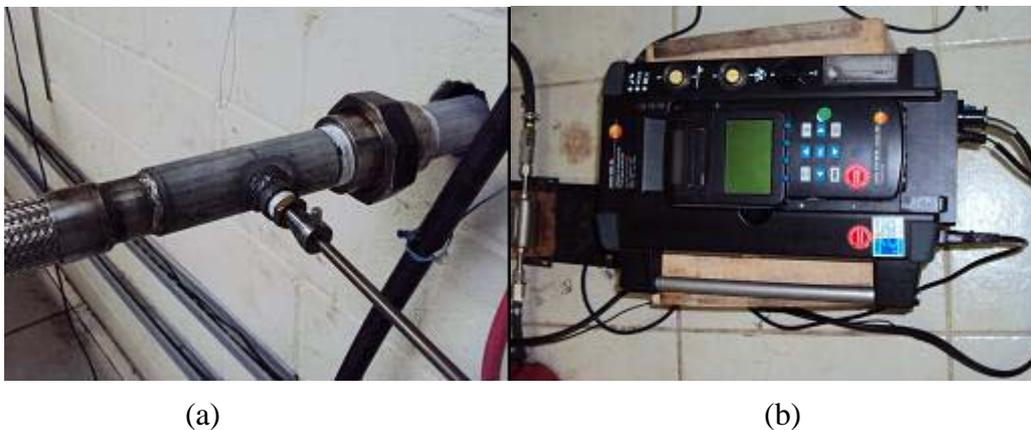
Figura 21 – Sistema de medição de emissões.
