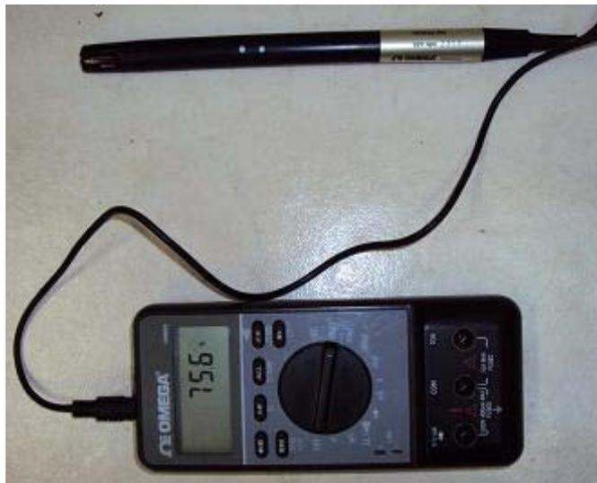
Figura 16 – Medidor de umidade relativa e temperatura Omega HHM25
