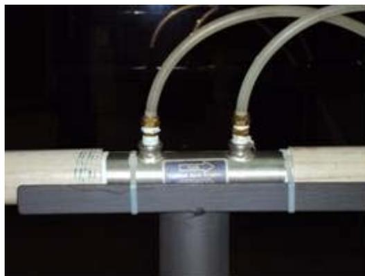
Figura 20 – Medidor de Fluxo Laminar
