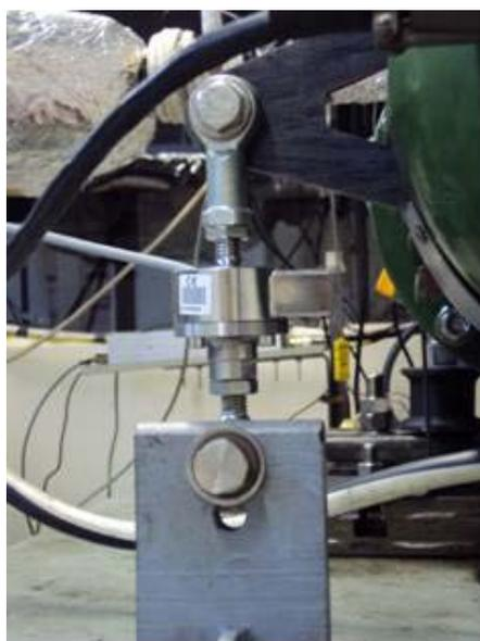
Figura 15 - Célula de carga U2A – 200
