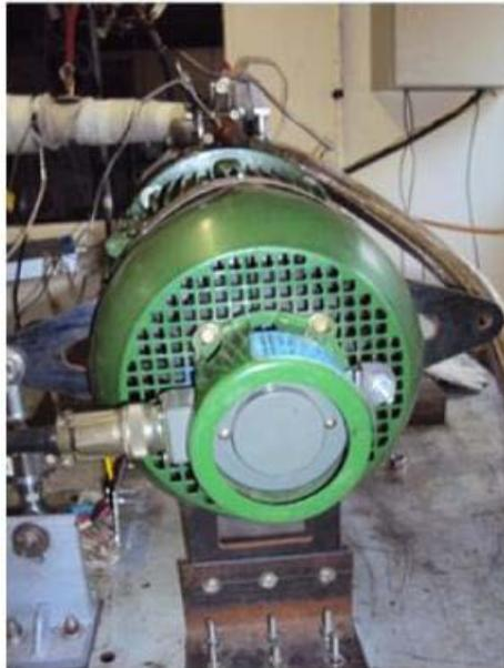
Figura 14 – Encoder HS35. Tipo incremental.
