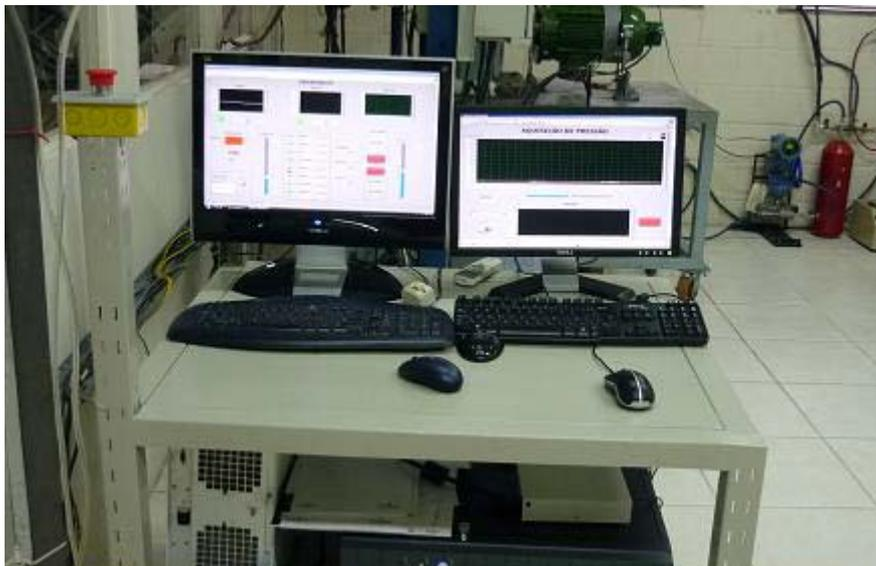
Figura 22 – Unidade de controle do dinamômetro (esquerda) e unidade de registro e visualização da pressão interna (direita).
