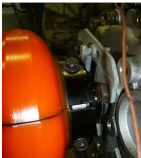
Figura 18 – Marca de referência para a determinação do ponto morto superior.
