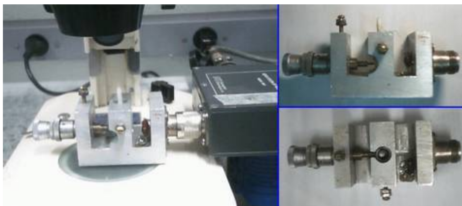
Figura 28: Dispositivo confeccionado para o ajuste da junção Josephson.
