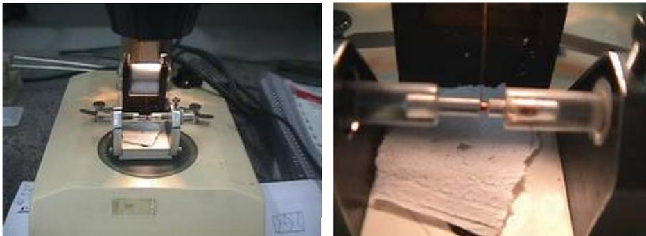
Figura 11: Enrolador de bobina de rf.
