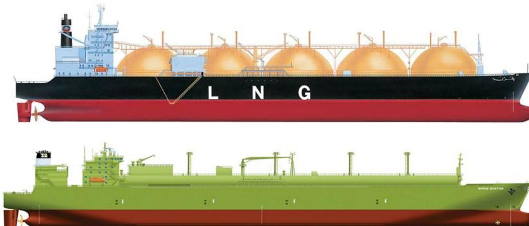
**Figura 29 - Os dois tipos de navio de transporte de LGN: de Esfera e de Membrana**
