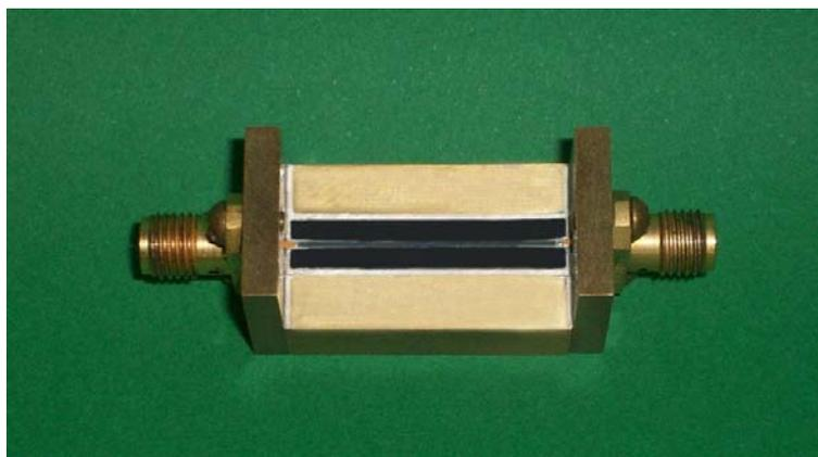
Figura 40. TLT “back-to-back” QCPW com filme fino de STO elaborado com perfil Chebyshev.
