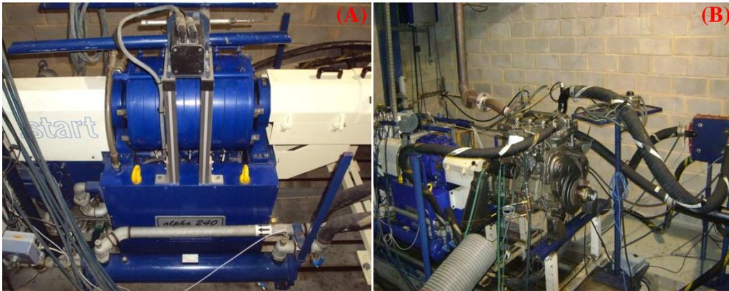
Figura 5 – Vistas do dinamômetro de bancada e motor em montagem para testes.
