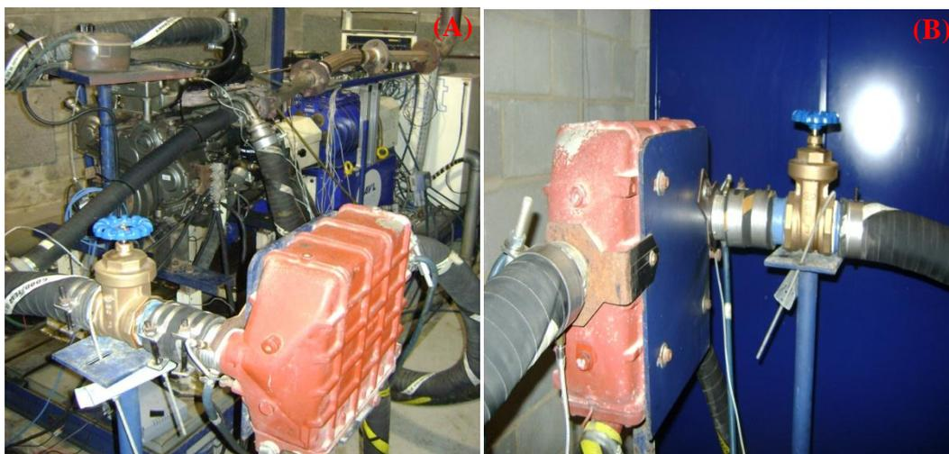
Figura 7 – Instalação da válvula manual usada na restrição do ar.
