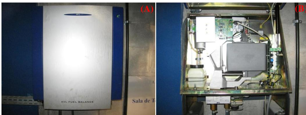
Figura 8 - Balança de combustível utilizada na medição do consumo de óleo diesel.
