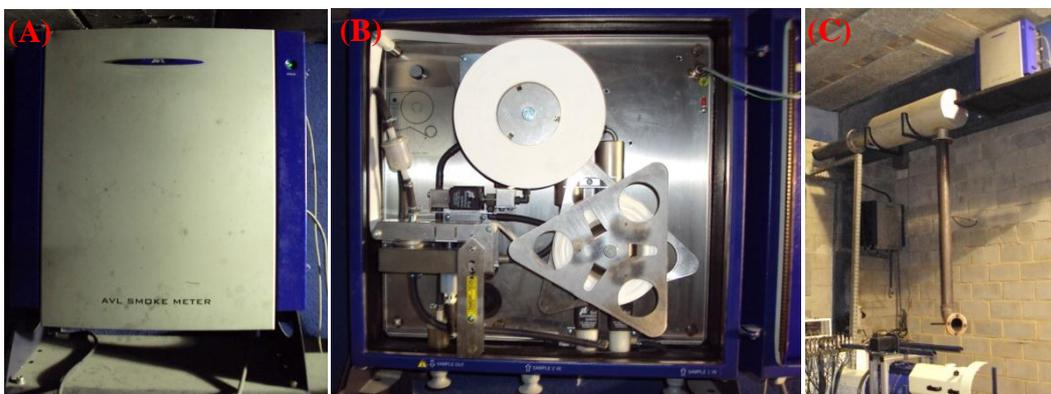
Figura 10 – *Smoke Meter* e ponto de amostragem no escapamento.
