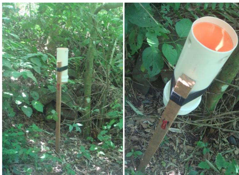
Figura 4.2. Pluviômetro simples em PVC.
