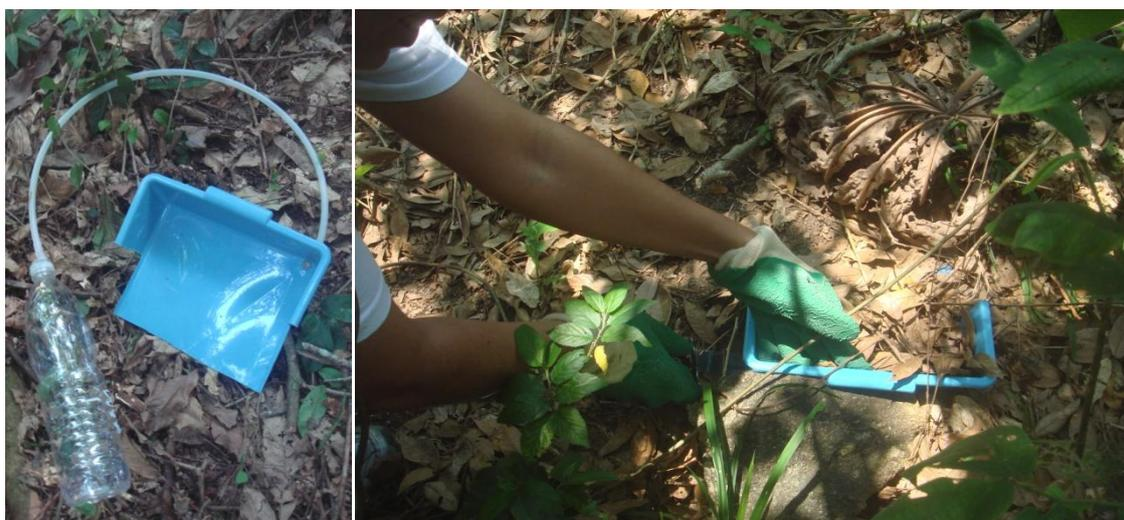
Figura 4.7. Fotos da bandeja coletora de precipitação terminal (Pt) e sua instalação.
