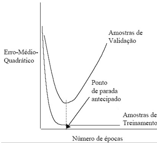
Figura 2.9: Monitoramento da função de custo de validação ocasionando um “early stopping” no treinamento de uma rede neural [28].
