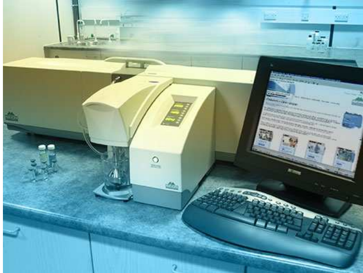
Figura 3-7 - Mastersizer 2000E, equipamento utilizado para as medições dos diâmetros das gotas.
