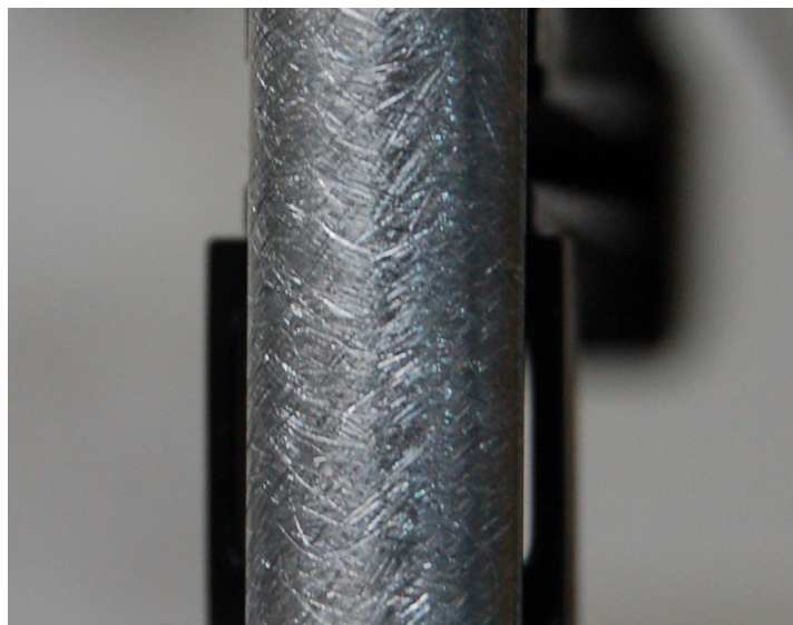
Figura 7.3 Montagem experimental do corpo de prova cilíndrico de aço, lixado para gerar texturização.
