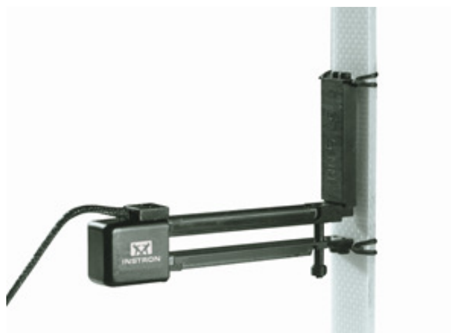
Figura 7.1 Extensômetro Instron montado no corpo de prova.
