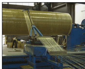
Figura A.5 - Processo de enrolamento de filamentos (Fonte: www.gilgwang.com ).
