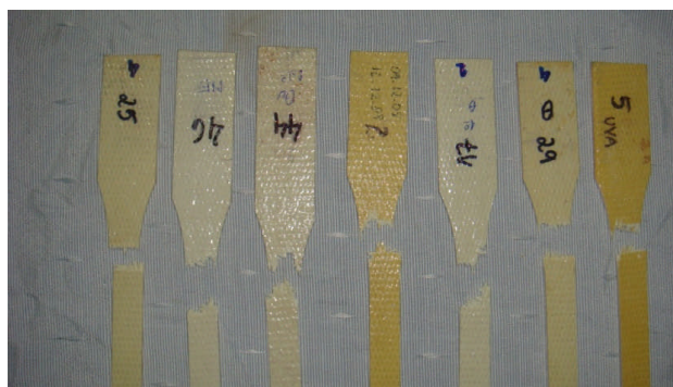
Figura 6.10 – Cp submetidos ao ensaio de tração
