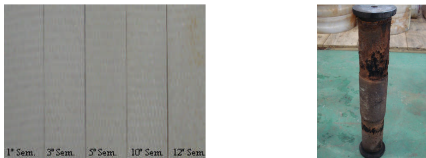
Figura 6.6 – Cp submetidos à água em temperatura de 70°C
