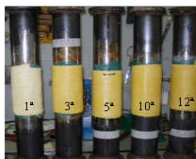
Figura 6.3 – Reparos expostos à radiação
