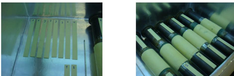
Figura 5.1 – Espécimes dentro da câmara de radiação UV
