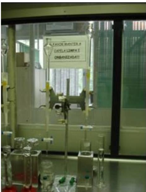
Figura 3. 14. Fracionamento de HPA em coluna de sílica/alumina
