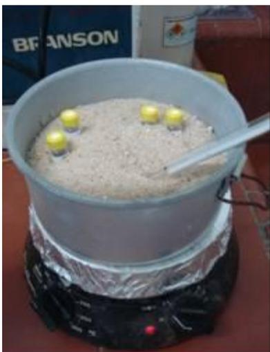
Figura 3. 10. Banho de areia para reação de hidrólise com temperatura controlada
