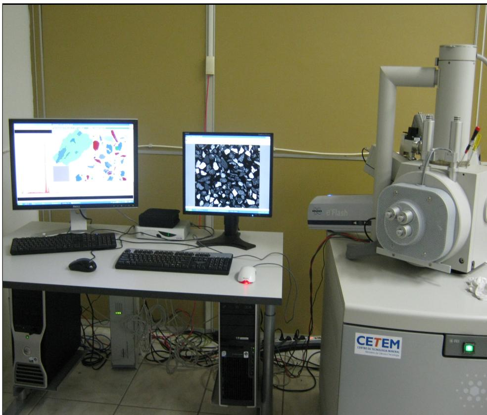
Figura 18 – Microscópio Eletrônico de Varredura FEI Quanta 400.
