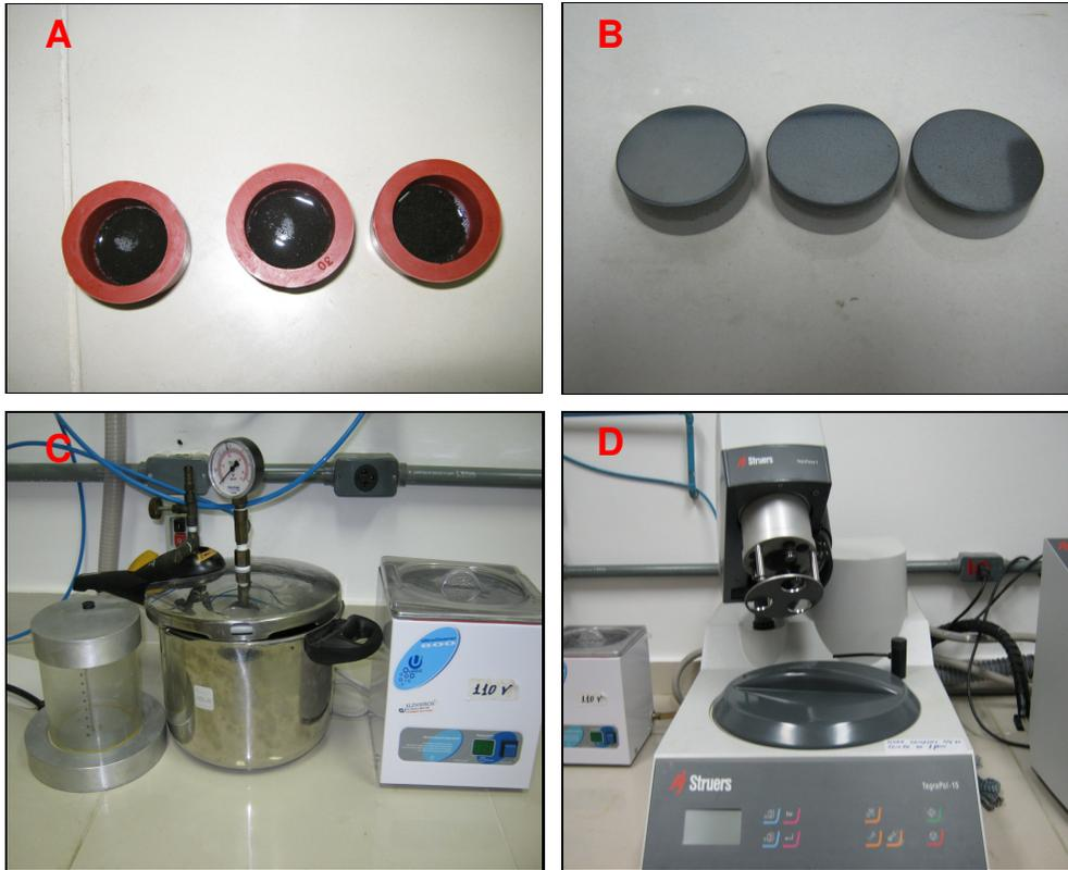
Figura 17 – Em (A), amostras embutidas, em (B), amostras polidas recobertas com carbono, em (C), banho ultrassônico câmara de vácuo e câmara de pressão, em (D), politriz automático Struers Tegra.
