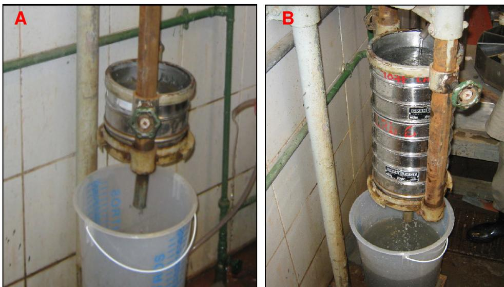
Figura 14 – Peneiramento a úmido. (A) Peneiramento de finos, (B) Série de peneira Tyler.
