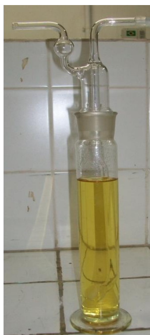
Figura 21 – Lavagem da corrente gasosa que deixa o gerador de ozônio em solução de iodeto de potássio
