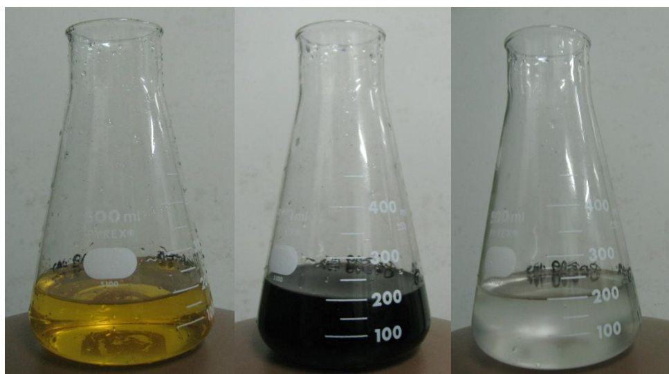
Figura 22 – Titulação da solução de iodeto de potássio na corrente gasosa. O ozônio produzido foi calculado pela fórmula 14.
