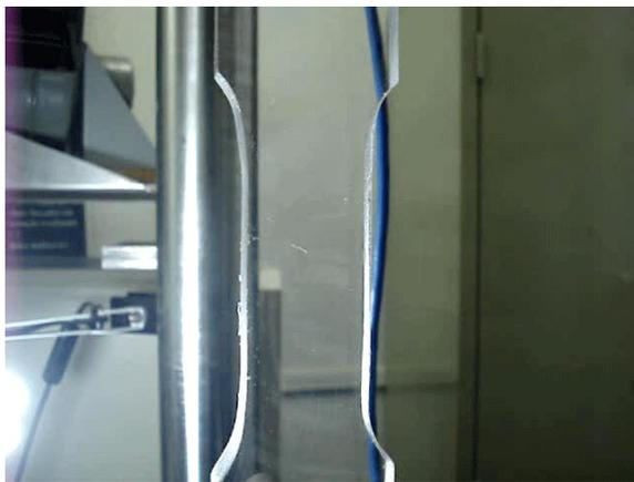
Figura 4.17 - Ensaio de tração uniaxial, (Lab. Fadiga PUC-Rio, 2010)
