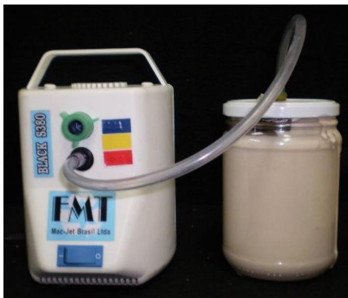
Figura 3.5 – Processo para retirada de bolhas da mistura
