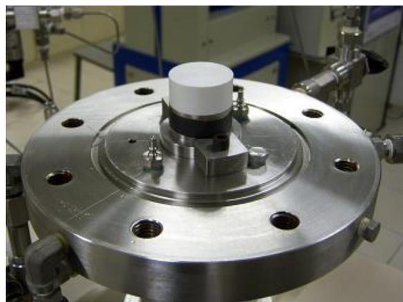
Figura 5.6 – Corpo de prova de PVC maciço na célula de difusão.
