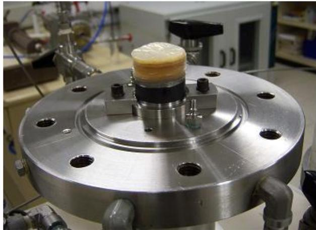
Figura 5.1 – Corpo de prova sintético na célula de difusão.
