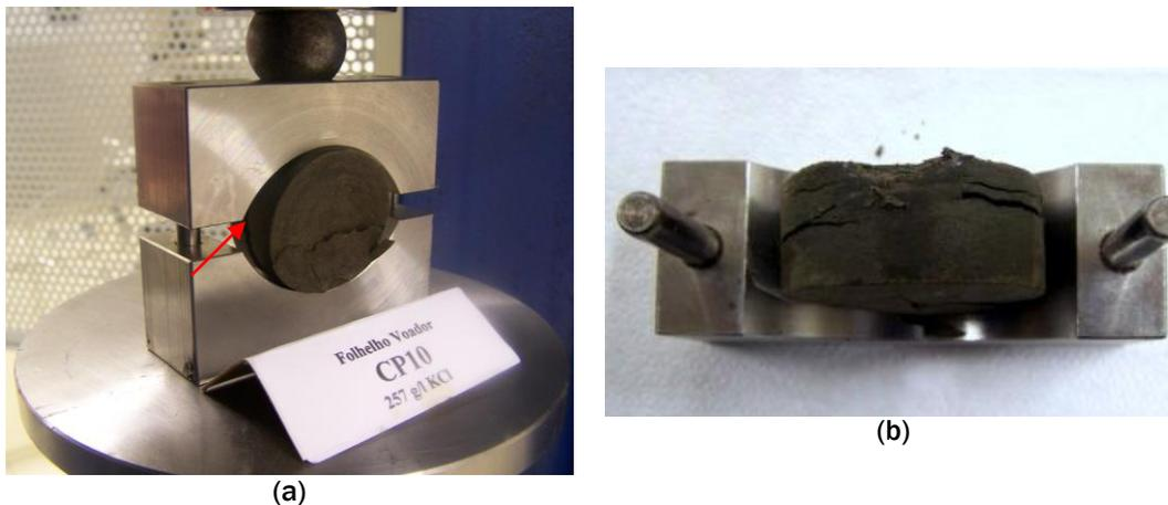
Figura 5.50 – Rupturas ocorridas no folheto BC-01; (a) Vista frontal inclinada BC10 (CP10) e (b) Vista do topo.
