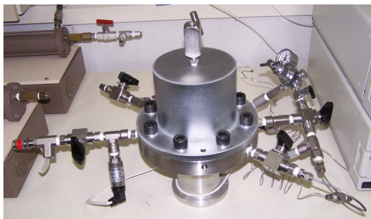
Figura 4.2 – Nova célula de difusão do LIRF-GTEP para ensaios isotrópicos.
