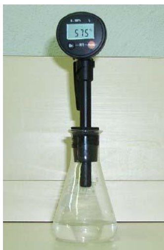
Figura 4.13 – Ensaio para obter a atividade química da solução (Rabe, 2003).
