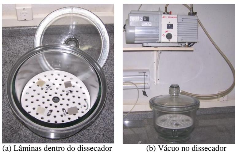
Figura 3.16 – Processo de glicolagem das lâminas
