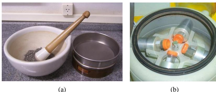
Figura 3.12 – (a) Destorroamento do folhelho e peneiramento na malha de 40# (b) Processo de centrifugação.
