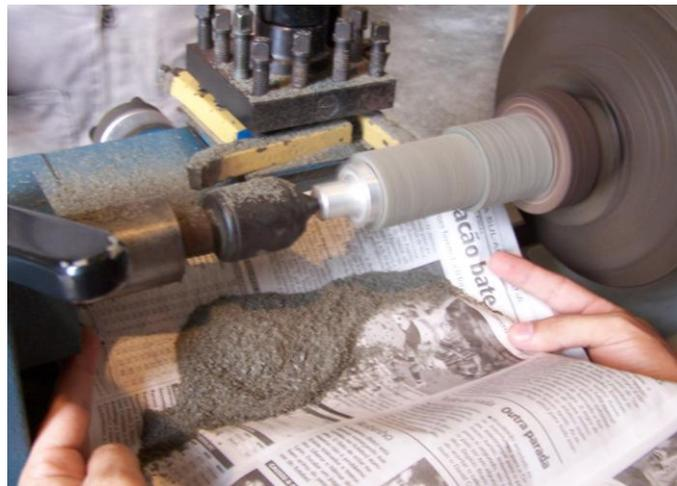
Figura 3.2 – Preparação dos corpos de prova em torno mecânico.
