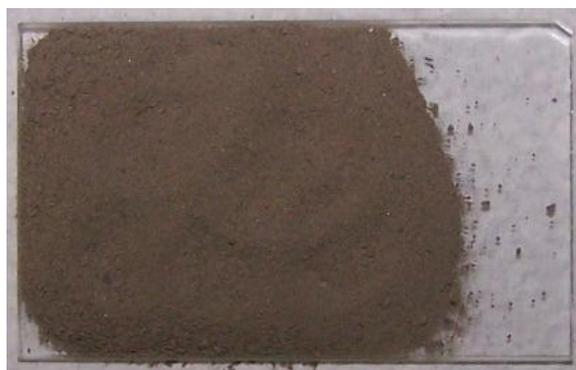
Figura 3.13 – Imagem ilustrando a lâmina da fração total preparada utilizando o método do pó.
