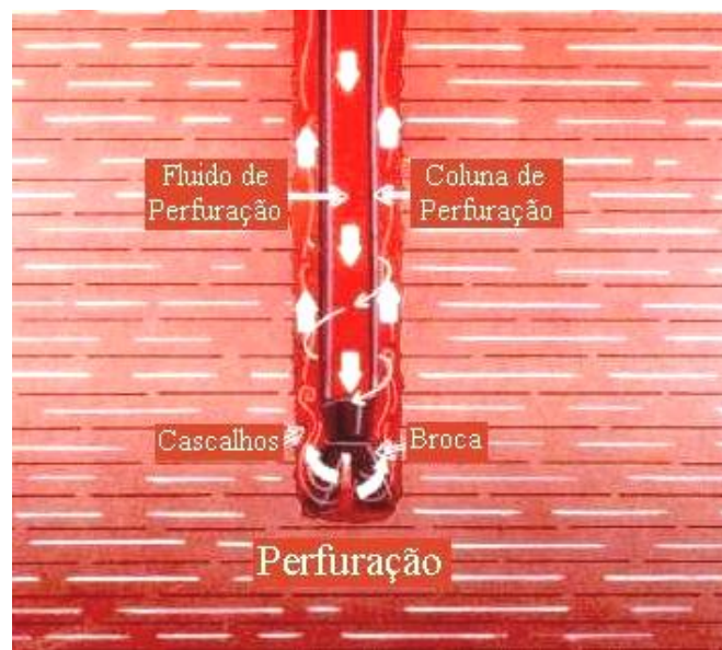
Figura 2.7 – Fluido de perfuração carreando os cascalhos para a superfície (Duarte, 2004).
