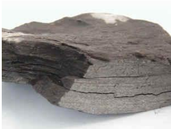
Figura 2.1– Amostra de folhelho com lâminas finas e paralelas esfoliáveis.
