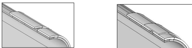
Figura 3.19 – Modelos com e sem reforço entre as mangas adjacentes
