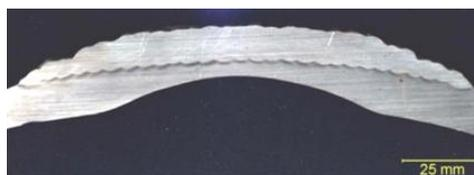
Figura 2.2 Defeito interno reparado com deposição de solda externa [22]
