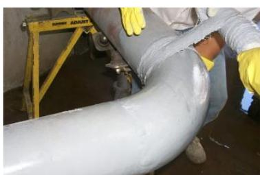
**a. Curvatura STD 6" (50% corrosão)**
