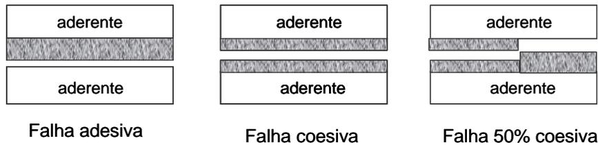
Figura 2.14 – Tipos de falhas nas juntas coladas
