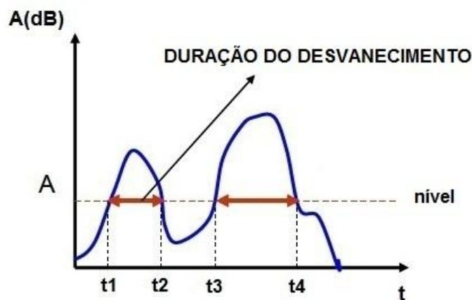
Figura 4.10 – Ilustração da duração de desvanecimento
