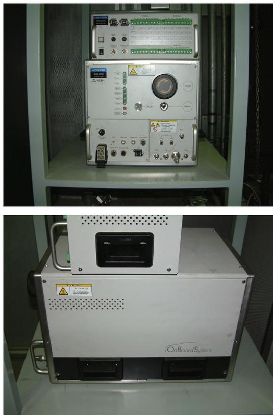
Figura 4.11 – Equipamento para medição de emissões, Horiba OBS 2200.
