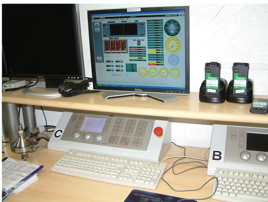
Figura 4.1 – Interface de usuário do sistema de automação AVL PUMA OPEN.
