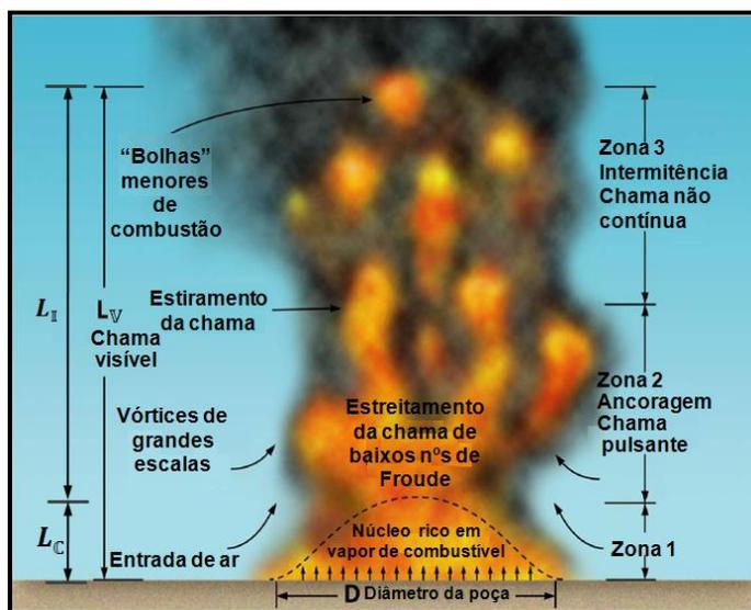
Figura 6.6 - Modelo de três zonas da TMS (2006)
