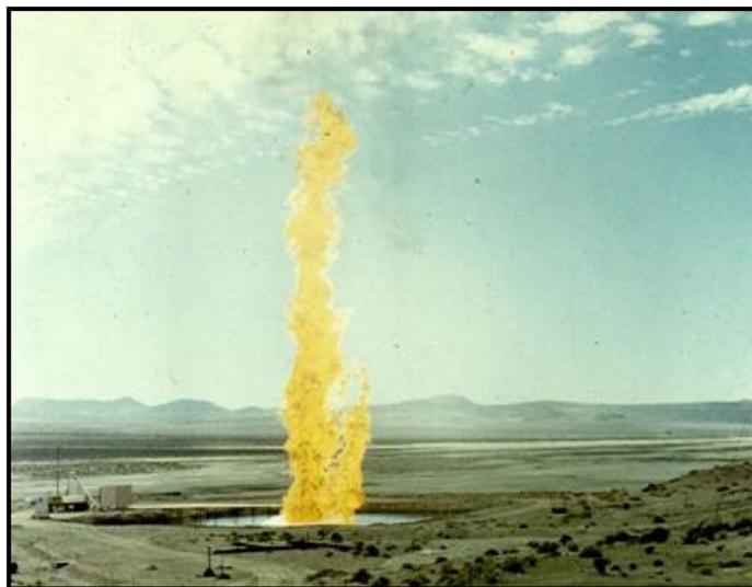
Figura 5.10 - Incêndio de poça de GNL na água. Teste nº 5 de 'China Lake', poça com 13 m de diâmetro
