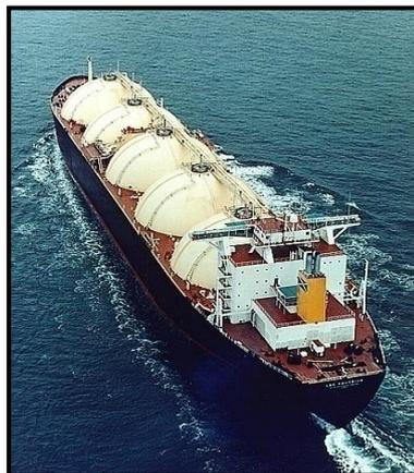
Figura 4.2 – Carrier com 5 tanques esféricos. Fonte: ABS (2006) (Cortesia)
