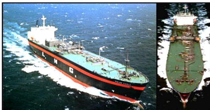
Figura 4.4 – Carrier com tanques prismáticos tipo SPB®
