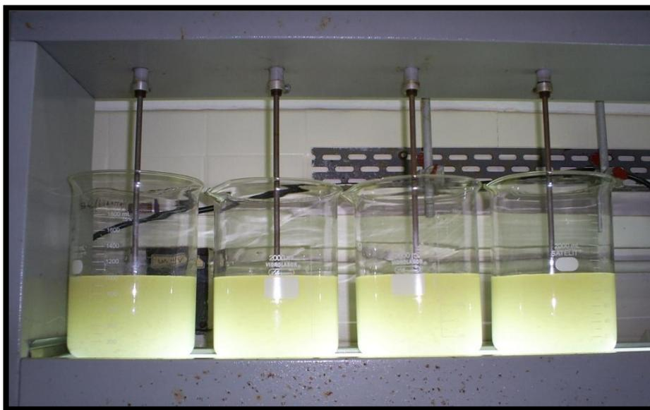
**Figura 25.** Ensaios de bio-sorção com *Jar Test*
