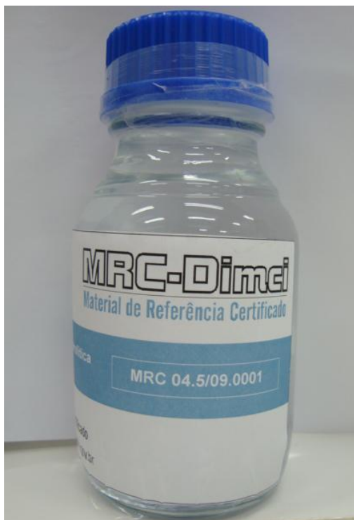
Figura 18 - Material de Referência Certificado de valor nominal de 5 \mu\text{S}\cdot\text{cm}^{-1} .
